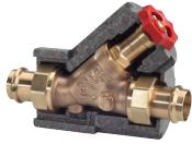
**3955** EPP-Dämmbox für CR-Messing, Rotguss und ECOCAST Freistrom- / KFR-Ventile **mit Aussengewinde**, nach EnEV, bis 110° C Dauertemperatur
